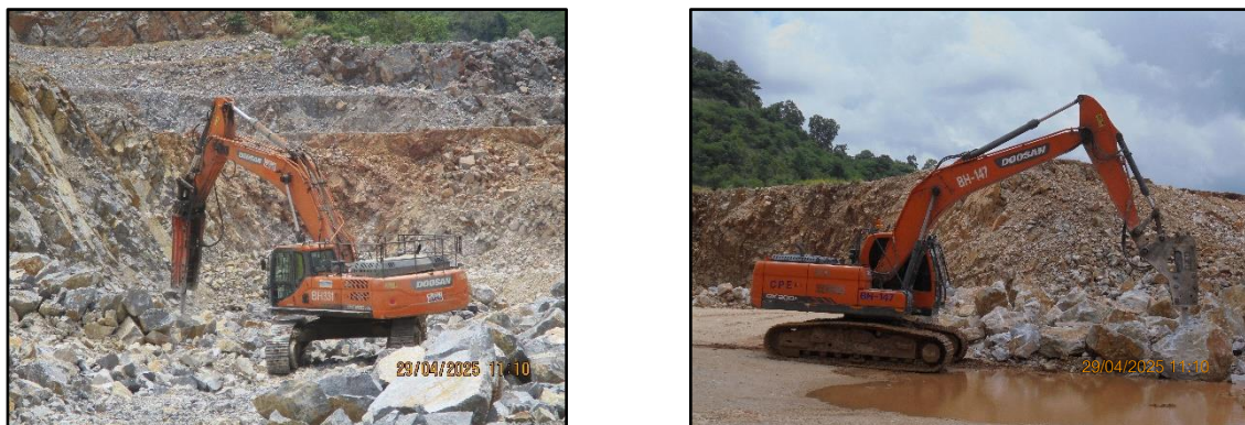
ภาพที่ 2.29 Hydraulic Breaker สำหรับทุบหิน
