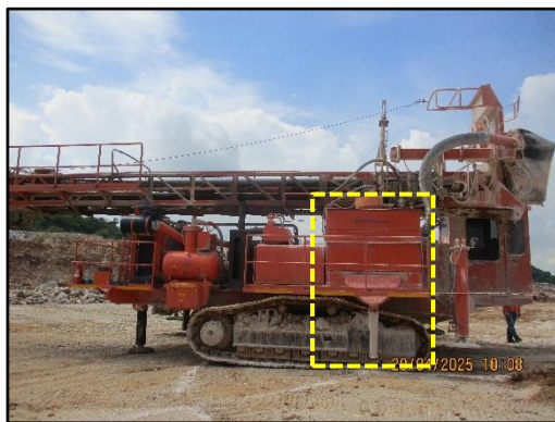
ภาพที่ 2.11 ตัวอย่างถูกรองฝุ่นประจำรถเจาะระเบิด
