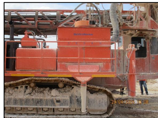
ภาพที่ 2.11 ตัวอย่างถูกรองฝุ่นประจำรถเจาะระเบิด
